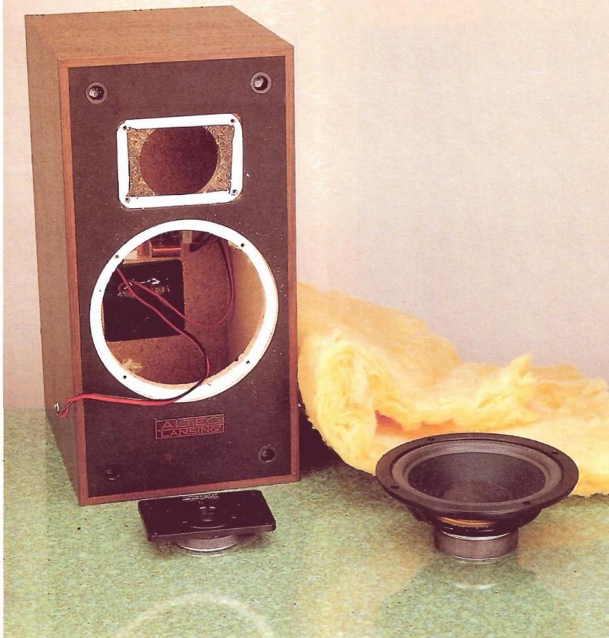
◀ Il mobile delle 990R è tutto in truciolare di buono spessore rivestito con foglia vinilica. Il pannello frontale presenta bassifondi sia per il woofer che per il tweeter, montati con l'interposizione di guarnizioni. L'assorbente acustico è classica e ottima lana di vetro.
